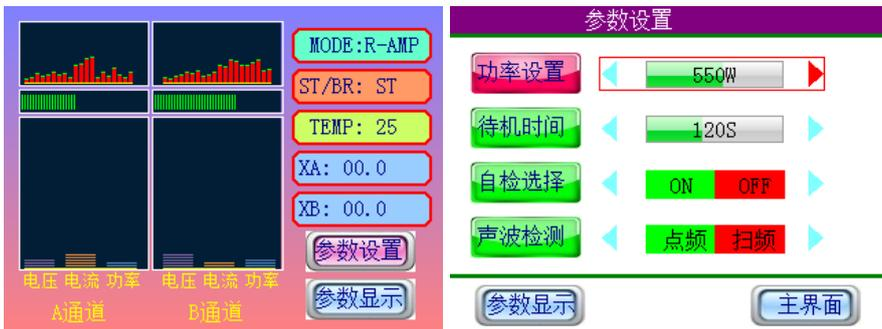
用户可以自行设置功率输出, 以 10W 为数量级进行改变, 可以自己选择功放界面待机时间, 可以自己选择开机自检功能关闭与否, 声波检测主机本身产生频率信号对负载进行检测。点频信号为从 20HZ 起每隔 100HZ 发送一个频率段信号, 扫频信号为从 20HZ 到 20KHZ 发送不间断全频信号, 此功能为自检本机频率响应曲线。
