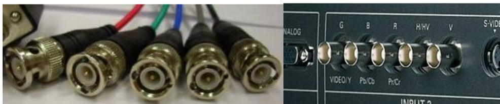
BNC 接口：三基色 BNC 端子（或称 RGB 端子），BNC 端子这种是很容易与一般色差端子混淆，三基色 RGB 端子的情况比分量色差端子要复杂些。因为它既有模拟的，又有数字的；有三个接头、4/5 个接头、也有 6/8 个接头，甚至十个接头。
