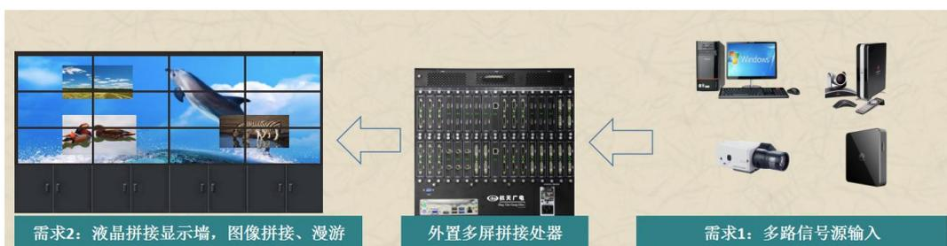
液晶显示系统由三大部分组成，即拼接显示墙、液晶拼接处理器和信号源、多屏拼接处理器功能优势：
