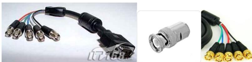
RGBHV (Red/Green/Blue/H-sync/V-sync)，用 5 个 BNC 端子接收红、绿、蓝水准同步和垂直同步信号。由 R、G、B 三原色信号及行同步、场同步五个独立信号接头组成。主要用于连接工作站等对扫描频率要求很高的系统。通常用于工作站和同轴电缆连接，标准专业视频设备输入、输出。
