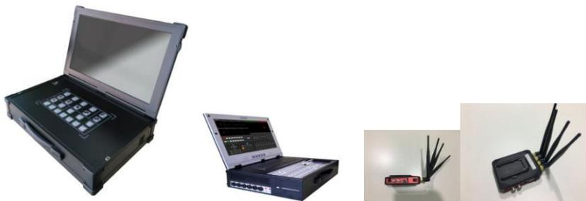
HT-S800M 是一款便携式 8 机位录播设备、它采用性能更加强大全高清图像处理芯片，3G/HD-SDI 信号自适应。硬件接口更加丰富，兼容 HDMI、VGA、3G/HD-SDI、3.5mm 耳机接口、RJ45 网口，6 路 SDI 接口自适应 3G-SDI/HD-SDI 信号，每个接口都支持 1080P60 图像输入；1 路 HDMI 独立输入，1 路 HDMI 和 1 路 VGA 选择性输入，并且这 3 路输入均带环出接口，自带 17.3 寸高清显示屏，后面板共有 3 路输出：默认 VGA-OUT 和 HDMI-OUT-2 输出录播导播画面，HDMI-OUT-1 输出录播直播画面，分别满足在不同的显示器上显示。接上鼠标和显示器就可以进行导录播，也可以在 PC 和平板上登录 IE 进行远程导播，本地 UI 界面导播延时小于 100ms。内置导播切换按键，方便用户快速导播操作。用于户外直播、公开课、精品课等录播应用。
