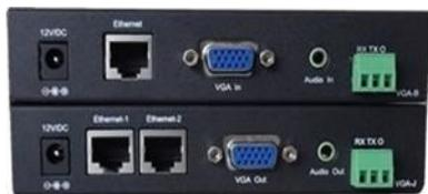
通过 120 米网线或 100M 网络传输 VGA、Audio，支持分辨率 1080P，可星型连接、串连。
