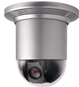
可自定义菜单编程和操作信息显示; 可吊顶, 内置 18 倍光学变倍、12 倍数码变倍、自动聚焦 SONY 一体化机芯, 具备高速云台功能、128 个预置位, 并具备定时校准复位功能; 支持 SONY VISCA、PELCO P/D (RS232C、RS422) 通讯协议的视频会议摄像机。
