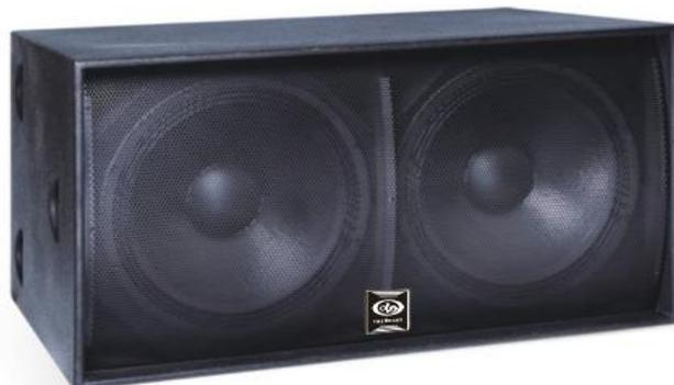
HT-S218 超低音箱是用于补充全频系列音箱的低频表现力。S218 超低音箱为消除箱体的共振和颤动影响高冲出瞬态响应能力。音箱均采用 18 mm 多层夹板，并施以重压、加固处理，以达到低音结实有力的效果。箱体内部的金属连接件将箱体连接为一体，使箱体可靠性提高，内置 2 个 220 磁 100 芯 18"低音单元，有超强的低频撞击力。
