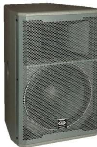
是一款高保真、多用途的音箱。整个系列的扬声器单元均选用进口单元材料，通过电脑精密校准使其相位、频响曲线平滑，箱体内部的金属连接件将箱体连接为一体，使箱体可靠性提高。内置 12"低音单元和 1.75"高音喇叭，号角覆盖角度  $80^{\circ} \times 50^{\circ}$ 。
