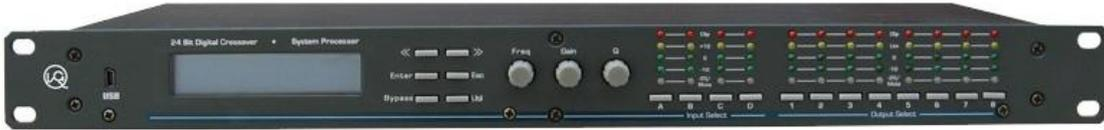
4 输入 8 输出数字音频信号处理器。它可配置立体声 4 路 2 分频，立体声 3 分频，立体 4 分频，乃至 8 分频架构。它采用最合适的高性能零件，以求取得最好的音频效果，最低的失真及噪音。采用 32 比特（可扩展至 64 比特）的数码处理器作为中心处理，并采用浮点设计，这一设计可大大提升动态范围，比 24 比特的设计质量高出很多倍。这一设计亦是今天音频处理器之中最高级的设计。有友好的、容易使用的用户界面。它给输入/输出信号控制上提供最大值控制和灵活性。可以通过附带的软件连接计算机的 RS232 接口作为远程控制。
