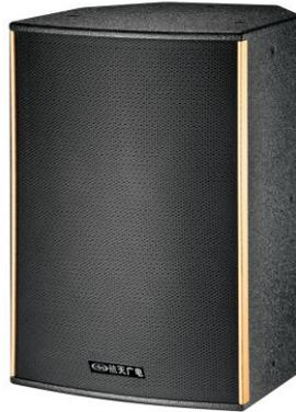
5115 音箱是一款高保真、多用途的音箱。整个系列的扬声器单元均选用进口单元材料，通过电脑精密校准使其相位、频响曲线平滑，全箱采用桦木板制成，箱体内部的金属连接件将箱体连接为一体，使箱体可靠性提高。内置 15"低音单元和 3"高音喇叭，号角覆盖角度  $90^{\circ} \times 50^{\circ}$ 。可据情况调整垂直或水平。
