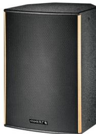
是一款高保真、多用途的音箱。整个系列的扬声器单元均选用进口单元材料，通过电脑精密校准使其相位、频响曲线平滑，全箱采用桦木板制成，箱体内部的金属连接件将箱体连接为一体，使箱体可靠性提高。内置 10"低音单元和 1.75"高音喇叭，号角覆盖角度 90° × 50°。可据情况调
