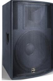
是一款高保真、多用途的音箱。整个系列的扬声器单元均选用进口单元材料，通过电脑精密校准使其相位、频响曲线平滑，箱体内部的金属连接件将箱体连接为一体，使箱体可靠性提高。内置10"低音单元和1.75"高音喇叭，号角覆盖角度 $90^{\circ} \times 50^{\circ}$ 。
