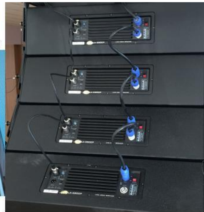
【线阵列全频音箱的连线方式】
