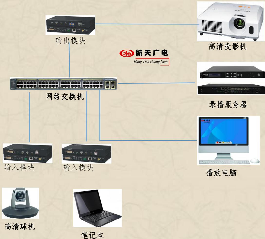
分布式交互系统可以直接以网络数据流的格式和会议录播服务器对接实现对会议内容的录制和播放等服务，与传统的解决方案相比，简化了对接流程，系统兼容性更强更稳定。
