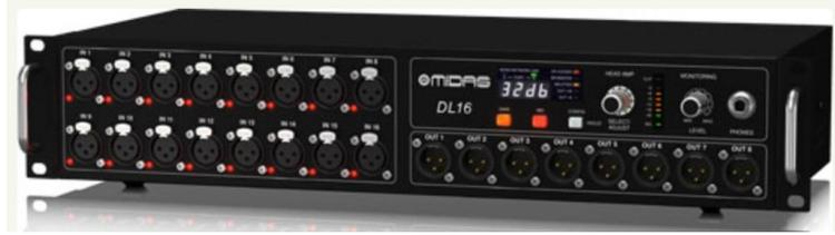
MIDAS DL16 数字舞台接口箱专为 MIDAS M32 数字调音台所设计，广泛应用于舞台区域。通过 AES50 接口，只需要一根 CAT5 线即可实现控制台与舞台之间的双向信号传输。配置有 16 个可编组输入和远程控制的 MIDAS 经典话放，8 个模拟平衡 XLR 输出。只需通过一根 CAT5 屏蔽线 (STP)，就可实现三台 DL16 接口箱的连接网络，为舞台设备提供 48 个输入通道和 24 个输出通道。双 AES50 接口为 M32 提供多达 96 个输入通道并可通过路由器连接在同一个系统中。便捷高效的应用，得益于 KLARK TEKNIK 的 SuperMAC 协议技术。2U 的机体设计，使 DL16 的应用更加便捷和广泛。
