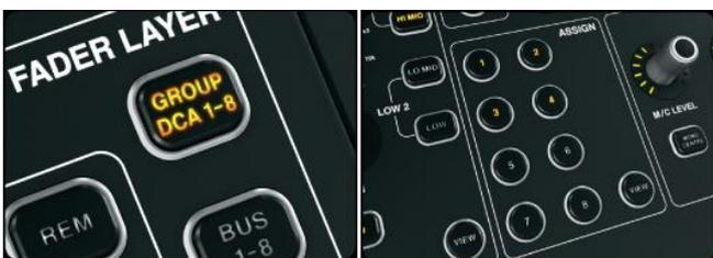
选择其中一个图层，八个自定义按键可触发你的参数设置开关，调节节拍时间或者触发跳转页面视图等。上面的功能键可以指定给不同的特定通道参数，然后可以对其进行调节。使用主显示屏上的旋钮，可以指定给不同的特定通道参数，然后可以对其进行调节。
