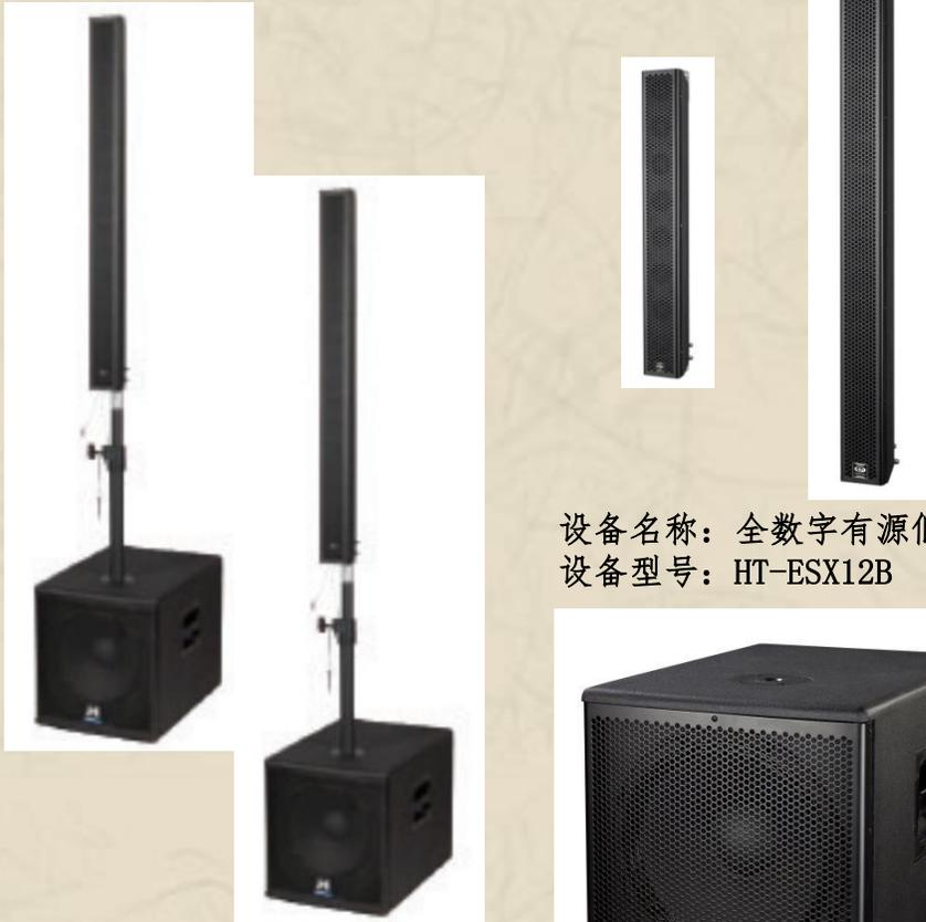
**\*16单元紧凑线性阵列**设计;线性排列,波束成型技术让传送距离更远\\***2寸全频**纸盆单元钕磁单元声音清晰度高声音定位清楚 \\*单体纸盆含浸处理,增强刚性,和室外防潮效果 \*水平扩散角110度;80~20kHz工作频段范围广可以不接超低音独立直接功放使用 \*垂直扩散角7度;使用射程远;衰减少;音压分布平均,近场聆听不刺耳;远场聆听清楚 \*全平面波特特性低回授啸叫特性;无压缩号角不会造成麦克风回授啸叫 \*指向性强;残响低 \*多功能不锈钢吊架支持音柱做0度/5度/10度集连的线性数组对接
