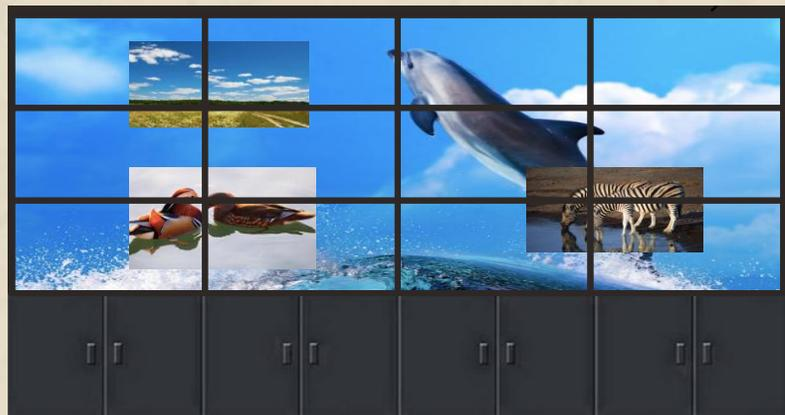
需求2：液晶拼接显示墙，图像拼接、漫游
