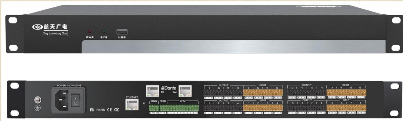
通道：16路平衡式话筒\线路输入，采用裸线接口端子；
