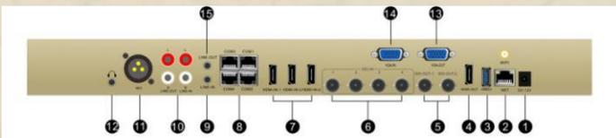
HT-S700-U是一款7机位录播设备。它采用性能更加强大全高清图像处理芯片，3G/HD-SDI信号自适应。同时兼容HDMI、VGA、3G/HD-SDI、3.5mm耳机接口、莲花头接口、6.5卡侬头接口、RJ45网口，4路SDI接口自适应3G-SDI/HD-SDI信号，每个接口都支持1080P60图像输入；2路HDMI独立输入，1路HDMI和VGA选择性输入\录播主机共有4路输出：默认VGA-OUT输出录播导播画面，HDMI-OUT和两个SDI-OUT输出录播直播画面，集成wifi模块，可在WIFI网络环境中进行图像网传和推流直播。自带web导播功能，用户既能在本地接上鼠标、导播台和显示器进行导录播操作，也可以在PC和平板上登录IE进行远程导播，本地UI界面导播无任何延时。录播主机前面板自带2寸液晶显示屏和控制按钮，一键查看录播直播状态、时间信息、网络信息、存储信息等，并且可以手动调整录播时间参数和IP参数。能满足摄制团队制作精品课程视频，满足老师独立操作拍摄的需求。
