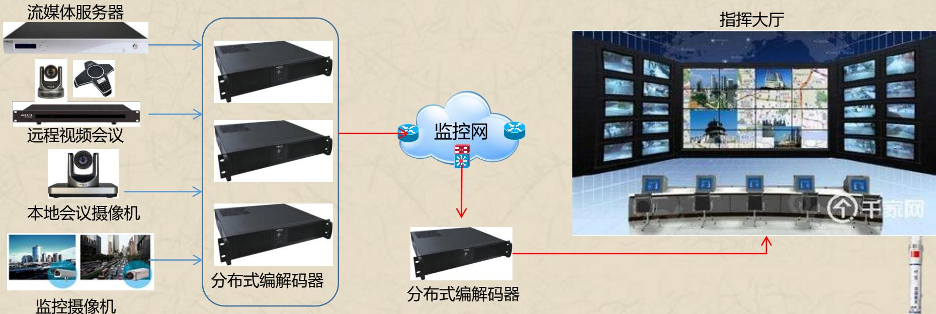
采用分布式节点控制；接入所有音频、视频信号，同过管理平台进行管理交换，信号上墙进行显示，实现信号互联、互通调度；
