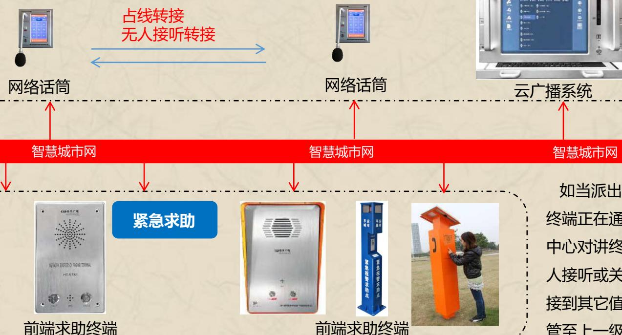
如当派出所值班室的寻呼对讲终端正在通话或离开岗位、监控中心对讲终端指定响铃次数后无人接听或关机状态下，会自动转接到其它值班室的对讲终端或托管至上一级指挥中心。
