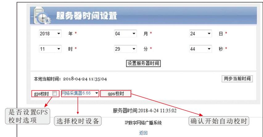
★备注：第一次设置校时时服务器会自动重启，以后会自动同步GPS时间，不需要重新设置，服务器和采集不需要连接互联网。
