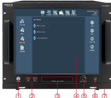
①. 电源开关      ②. USB接口      ③. CD光驱      ④. 15英寸触摸屏
