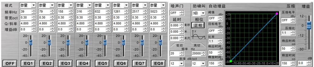
■输入通道有 4 级总反馈抑制，每个输入通道有单独的噪声门调节，范围：-120dBu 至 -40dBu；每个输入和输出均有延时和相位控制及哑音设置，输入最长可达 1000ms
