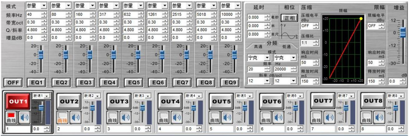
■ 单机提供 30 组设备数据存储，通过 PC 软件可进行设备之间的复制
