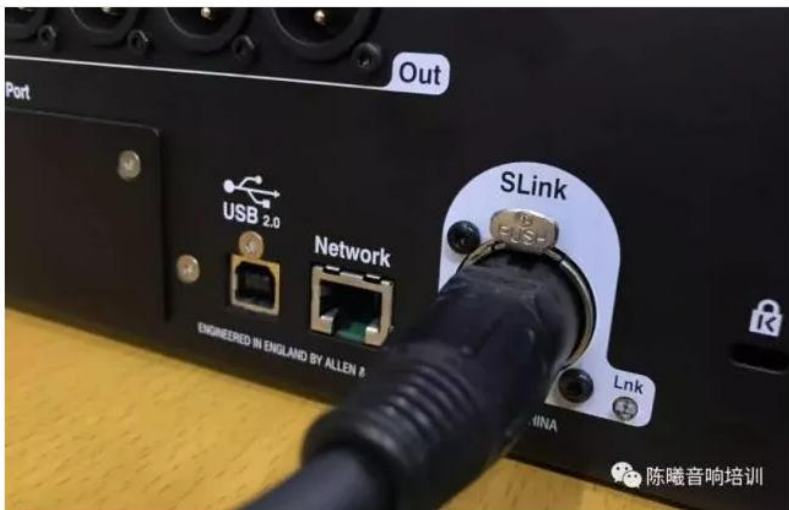
调音台通过SLink网口连接接口箱
