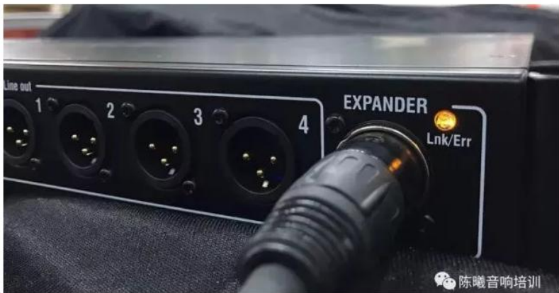
调音台通过SLink网口连接接口箱
