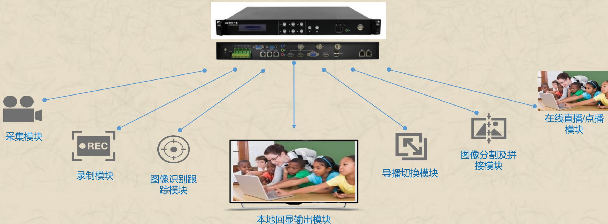
硬件一体化设计，内嵌采集模块、录制模块、直播模块、点播模块、图像识别跟踪模块、导播切换模块、图像分割及拼接模块、本地回显输出模块。
