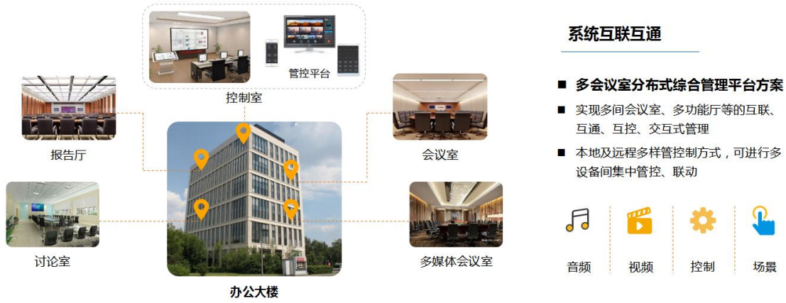
通过控制中心实现各个会议室之间音频、视频互联、互通。各会议室之间音、视频信号可任意切换。
