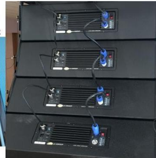
【串联全频音箱的连接方式】
